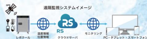
レボクール本体の遠隔監視 (位置、温度、CRB 状態、電子錠) ができます。標準モデルと一部扉の仕様が変更となります。
