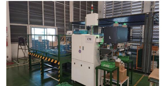
部品の形状をラインセンサーで瞬時に識別し、正確且つ効率的な計数が可能です。
