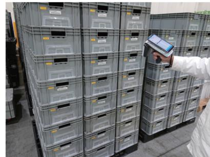
大量のコンテナバケットやパレット、台車といった生産活動に欠かせないマテハン機器の在庫管理にRFIDシステムを採用。RFIDの特徴である複数一括読取で効率の良い運用を実現し、早期にボトルネックを顕在化することで、お客様の計画外購買コストの抑制に貢献します。
