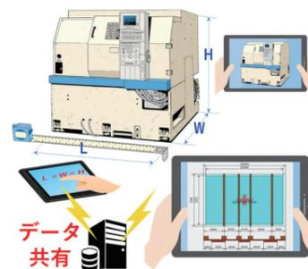
採寸作業の効率UPを目的にタブレットへ専用システムを搭載。
