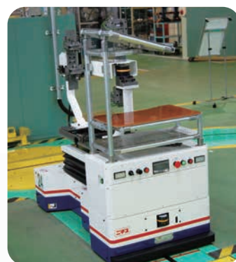
・作業工程毎に停止するループ台車(リフター機構付)
