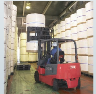
・ローテーティングロールクランプ仕様 「トランサー・フォルセア」
