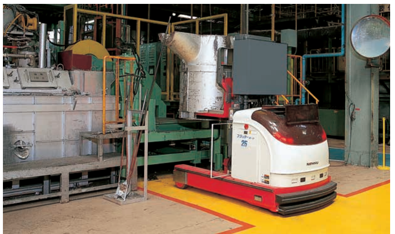
・24時間稼働で高温710℃の溶湯運搬に活躍する「ブラッターオート」
