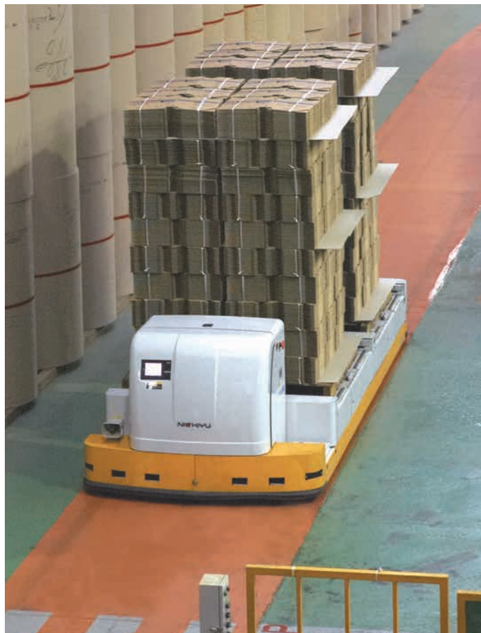
・段ボール生産工場で製品を搬送する「ムジーカー」(低床型)
