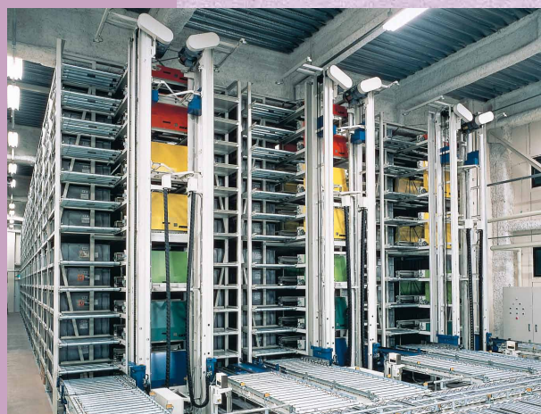
システムストリーマーSAS(立体高速ピッキング仕分機)
